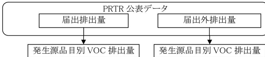
図 4-3 排出量の推計方法のイメージ(C PRTR引用型)
